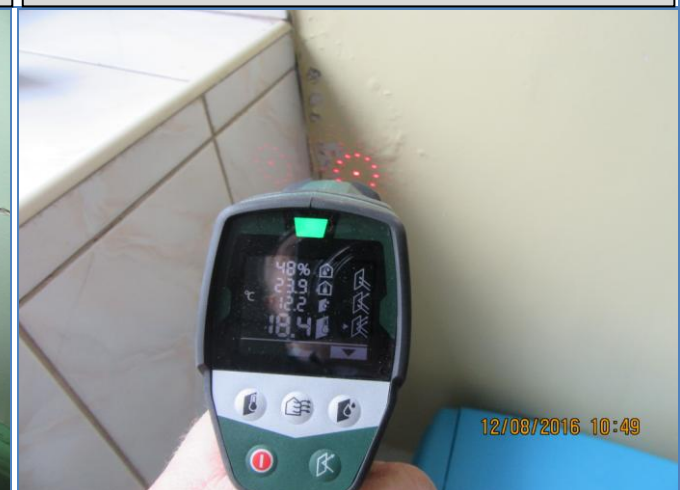
44.,45. att. Sienas virsmas mitruma mērījums ēdamzālē.
