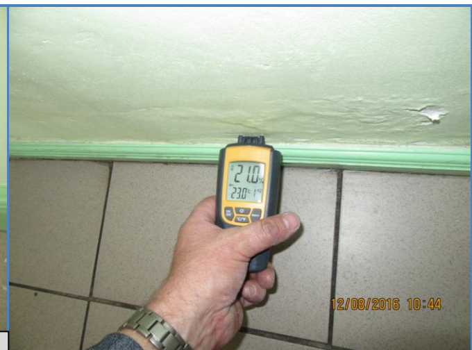
44.,45. att. Sienas virsmas mitruma mērījums ēdamzālē.
