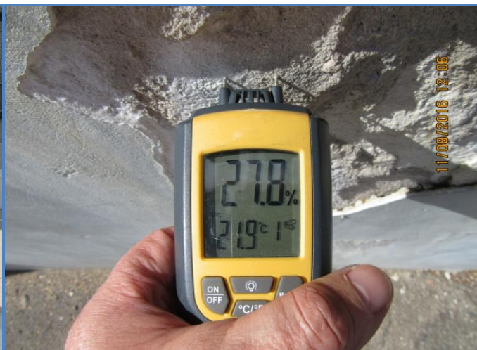
110. att. Dienvidu korpusa ieeja lieveņa virsmas mitruma mērījums.
