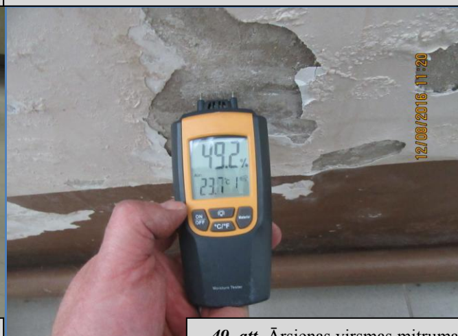
49. att. Ārsienas virsmas mitruma uzmērījums garderobes telpā Nr.3.
